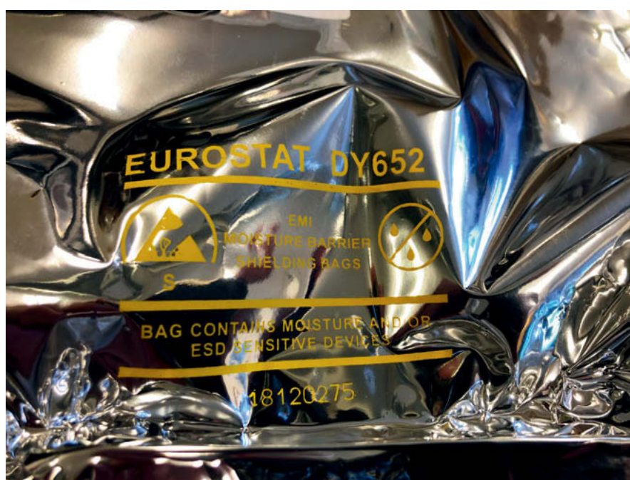
Rys. 1. Przykład pakowania płytek PCB w folie o specyfikacji ESD i MSD
