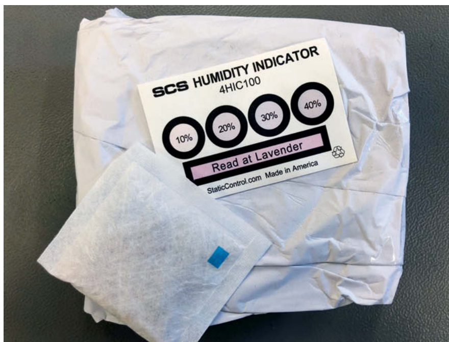
Rys. 2. Przykład pakowania płytek PCB ze wskaźnikiem wilgotności i absorbentem
